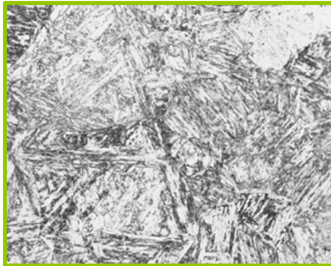
شکل ۶: مارتنزیت لایه ای، Fe-0.6C
